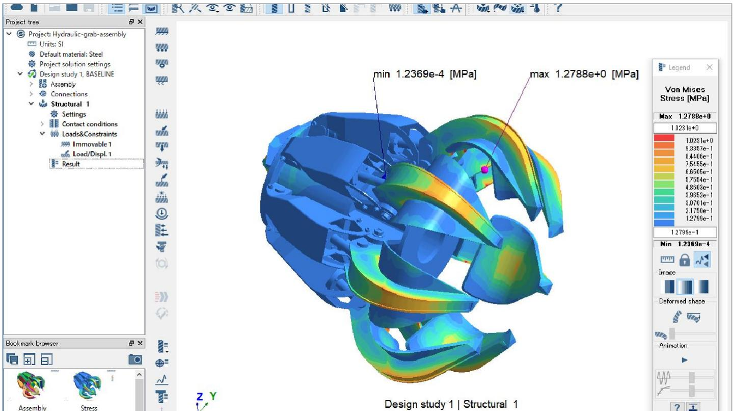
SimSolid ist eine Strukturanalysesoftware, die speziell für die Analyse komplexer Baugruppen entwickelt wurde. Es macht die Geometrievereinfachung und die Vernetzung überflüssig, die beiden zeitaufwändigsten und fachkundigsten Aufgaben in der traditionellen FEM, und ermöglicht die Analyse von CAD-Baugruppen in wenigen Minuten.
